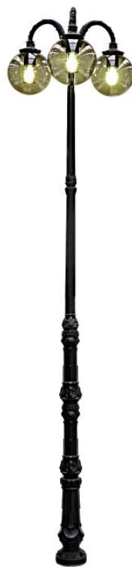
Опора S-52W/A, система консолей 3 вниз, светильник ОР, рассеиватели Шары дымчатые Ø450, растры из нержавеющей стали
