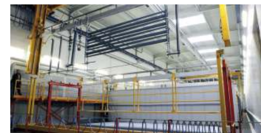
Опоры на подвесе после процесса анодирования
