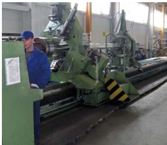
» Машина для вальцевания алюминиевых конусов
