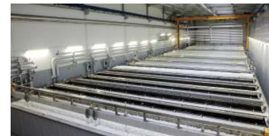
Завод по анодированию ROSA – технологические ванны для купания
