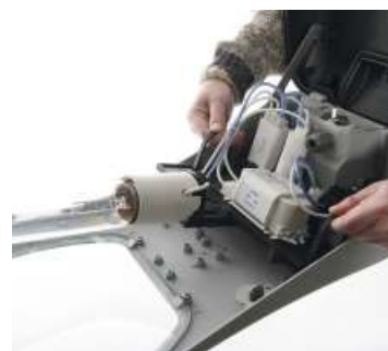
Способ демонтажа электрической оснастки ⌘
